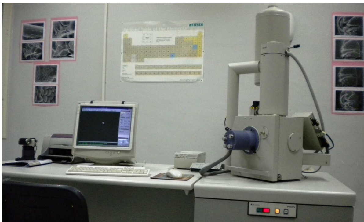
Figure II.9. Microscope Électronique à Balayage de type PHILIPS ESEM XL30.
