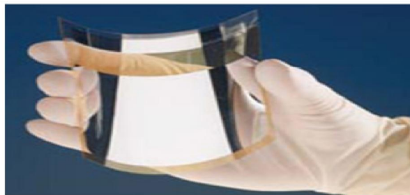
Figure I.10: phototype de cellule organique flexible et transparente
