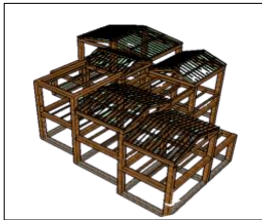
Figure 114 Ossature de bois dans notre projet, entité exposition et restauration. Source auteurs
