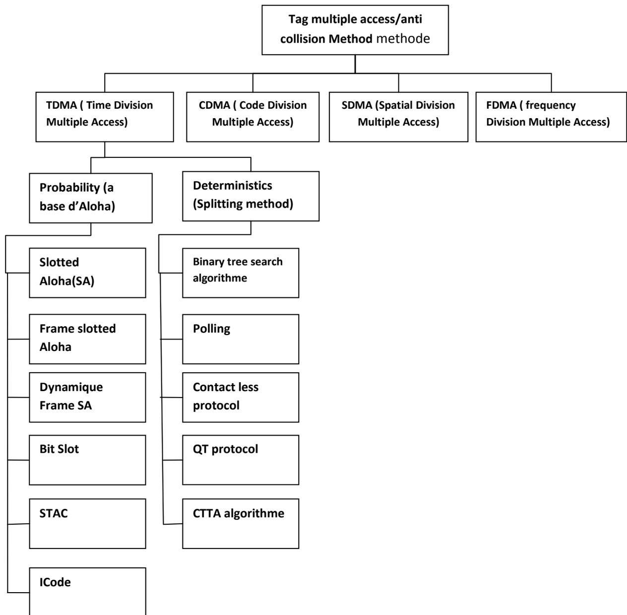
Figure 13: protocoles d’anticollision de tags.
