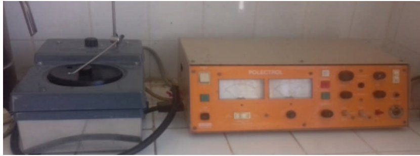
Figure III.34 : le dispositif utilisé pour réaliser l'attaque chimique
