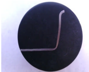
Figure III.27 : Echantillon a 15mm de Profondeur et rayon 1.5mm
