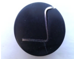
Figure III.29 : Echantillon a 20mm de Profondeur et rayon 1.5mm
