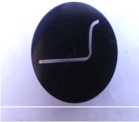
Figure III 25: Echantillon a 10mm de profondeur et rayon 1.5mm
