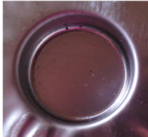
Figure III.9: pièce emboutie à 15mm de profondeur
