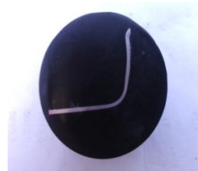
Figure III.28 : Échantillon a 10mm de profondeur et rayon 1.5mm
