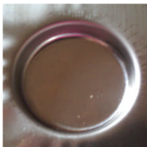
Figure III.7: pièce emboutie à 10mm de profondeur
