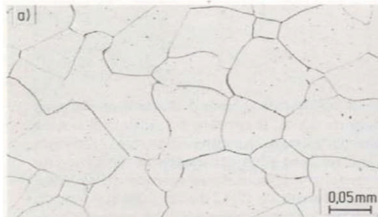
Figure I.1 : Microstructures des aciers inoxydables ferritiques.
