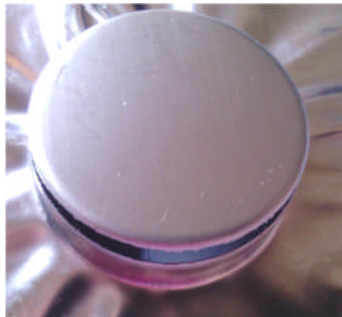
Figure III.18: pièce emboutie à 20mm de profondeur
