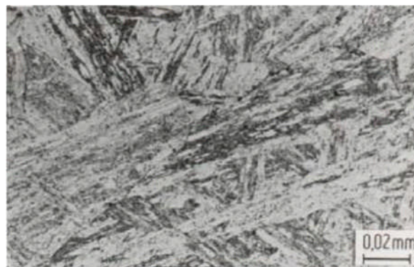
Figure I.2 : Microstructure des aciers inoxydables martensitiques.
