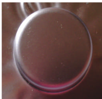
Figure III.16: pièce emboutie à 15mm de profondeur
