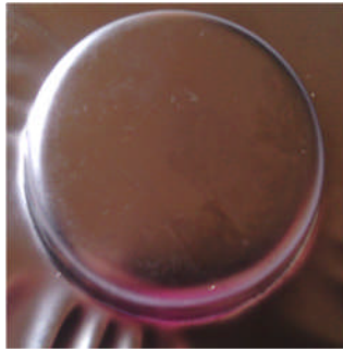
Figure III.14: pièce emboutie à 10mm de profondeur
