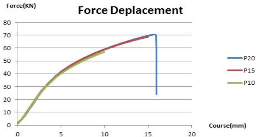
Figure III.13: superposition des courbes force/déplacement pour les profondeurs d'emboutissage de 10mm, 15mm et 20mm et pour un rayon de poinçon 1.5mm
