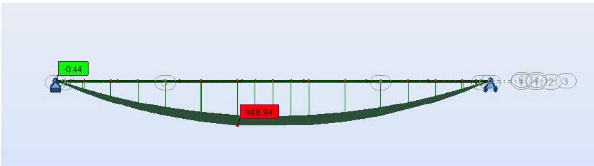
Fig -V-14: diagramme du moment fléchissant sous la combinaison la plus défavorable à l'ELS
