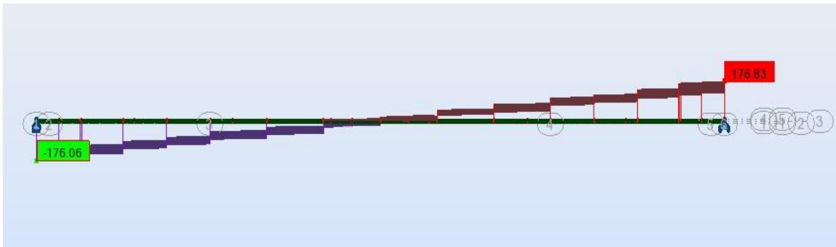
Fig -V-15: diagramme de l'effort tranchant sous la combinaison la plus défavorable à l'ELU
