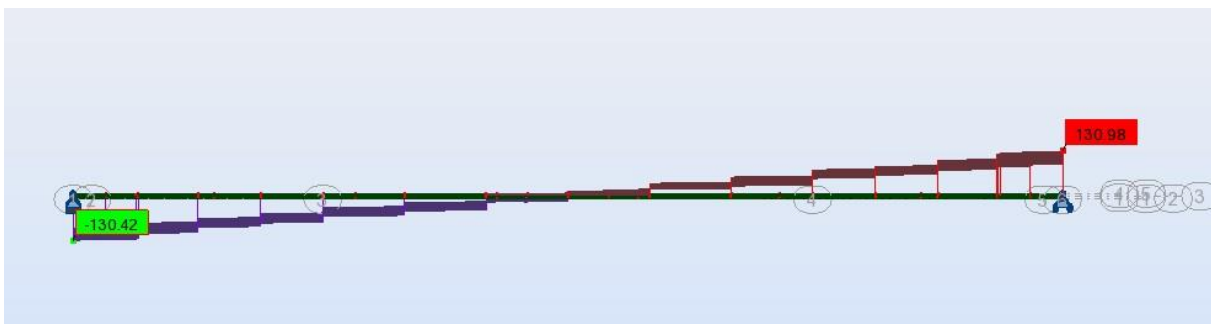
Fig -V-16: diagramme de l'effort tranchant sous la combinaison la plus défavorable à l'ELS
