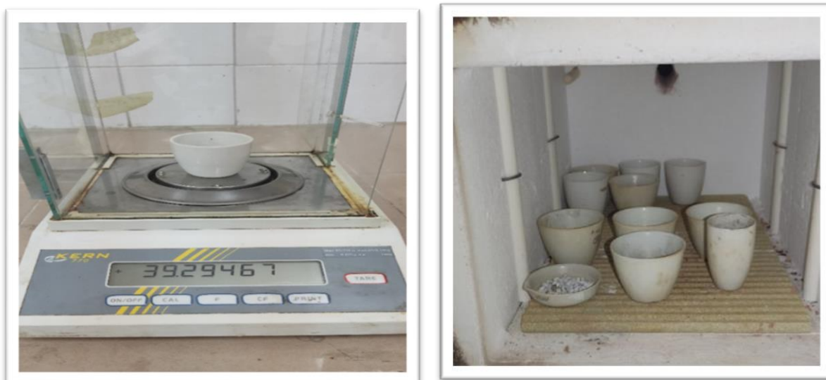
Figure 1 : Four à moufle et balance de précision utilisés.
