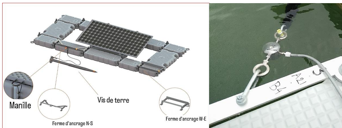
Figure.II.9. Système d'ancrage ou d'amarrage Solar first. [20].
