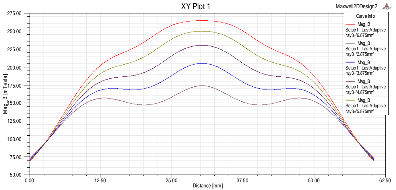
Figure 26: Répartition de l'induction Magnétique B [tesla] en fonction de la distance de l'arête (01)
