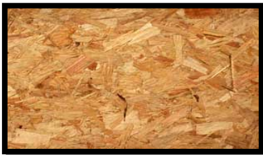
Figure 6: Aspect d'un panneau OSB
