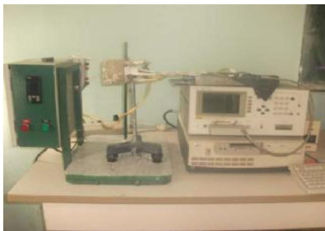
Figure IV.6: Photo de l'appareil de mesure des propriétés diélectriques.
