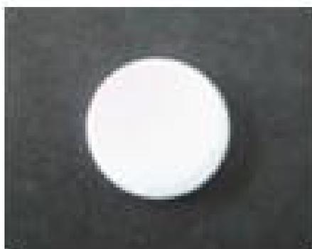
Figure IV.24: Pastille en fibre de laine.
