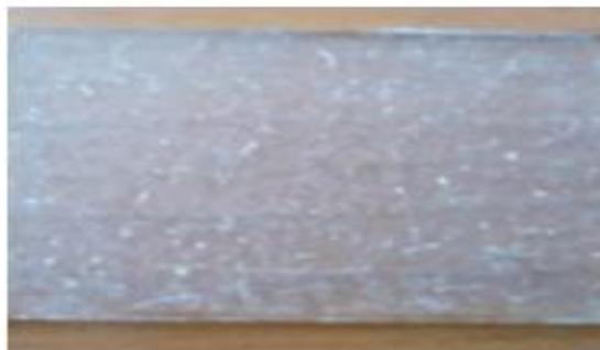
Figure IV.17: film obtenu sur une lame de verre.
