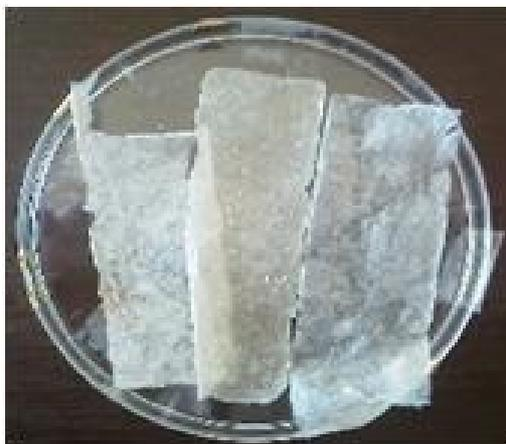
Figure IV.18: Les films détachés de lame en verre après immersion dans l'eau.
