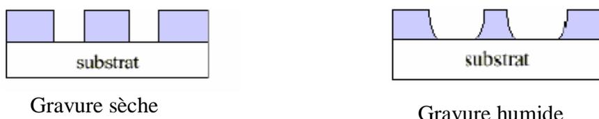
Figure III.4: Comparaison entre les gravures sèche et humide.
