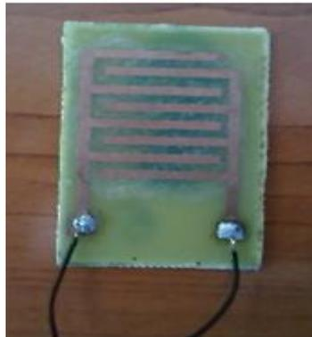
Figure IV.33: Capteur d'humidité à base de kératine
