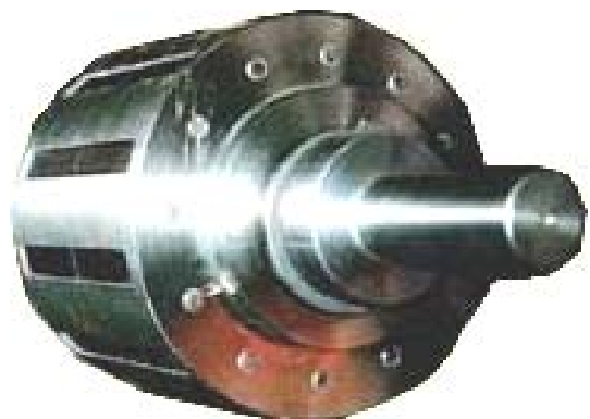
Fig I-6 : Rotor d'un moteur synchrone à aimant
