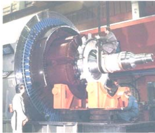
Fig I-4 : Rotor d'une machine synchrone à pôles saillants.
