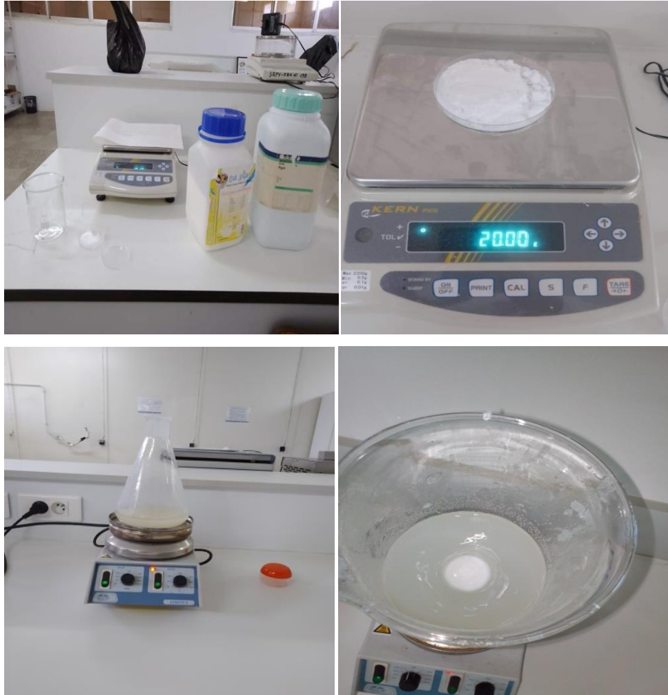
Figure 51: Mettre en agitation le glucose, la gélose, et l'eau de la pomme de terre (Original, 2022).
