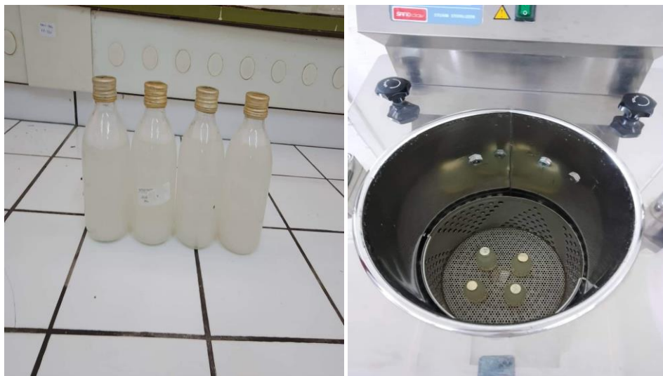
Figure 53: Mettre les flacons dans l'autoclave (Original, 2022).
