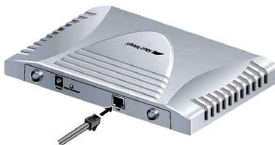
Fig. I.20. Raccordement du port RJ45
