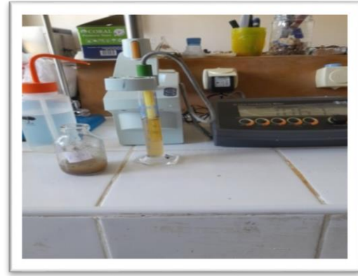
Figure 15. Préparation des échantillon pour la CE : a- pesée de fraction de terre fine (10 g) ; b- ajout d'eau distillée (50ml) ; c- séjour de la solution aqueuse ; d- mesure de la CE à du conductivimètre
