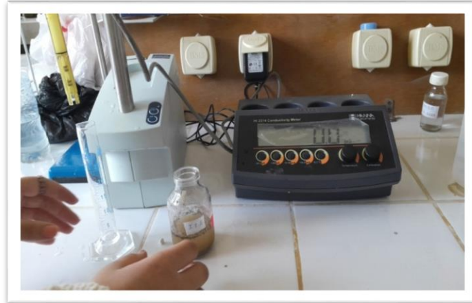
Figure 14. Mesure de la conductivité électrique
