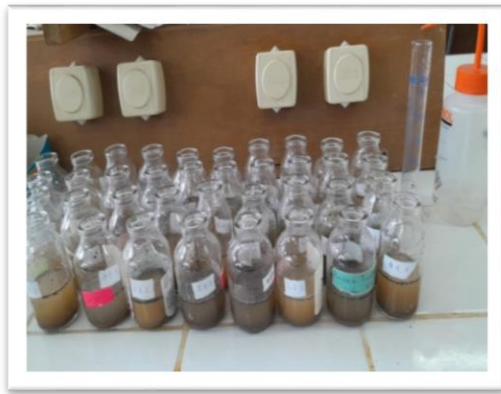
Figure 15. Préparation des échantillon pour la CE : a- pesée de fraction de terre fine (10 g) ; b- ajout d'eau distillée (50ml) ; c- séjour de la solution aqueuse ; d- mesure de la CE à du conductivimètre
