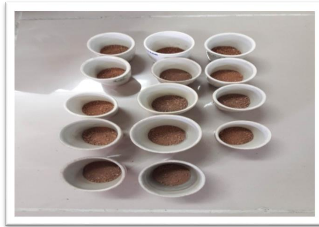
Figure 22. Echantillons après incinération à 450°C
