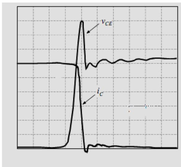
Figure (3.7) : Commutation à l'ouverture de l'IGBT
