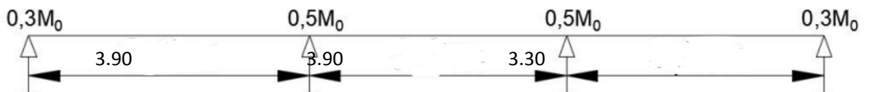
Figure III.15 schéma statique de la 2eme poutrelle
