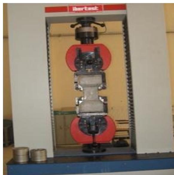
**Figure II.7.b : Essai de traction en cours d'exécution**
