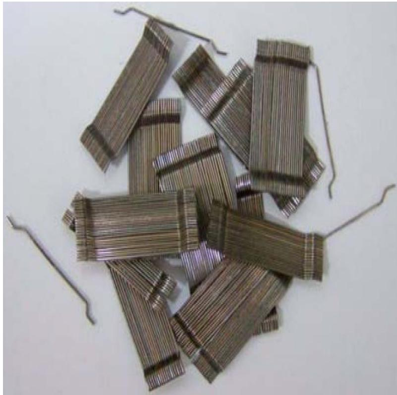
*Figure III.2 : Fibres Dramix utilisé pour le Materiau 1*
