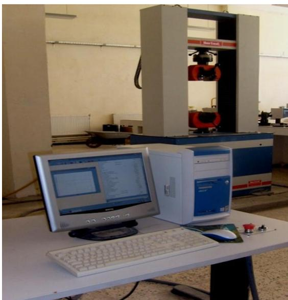
**Figure II.7.a : Machine de traction**
