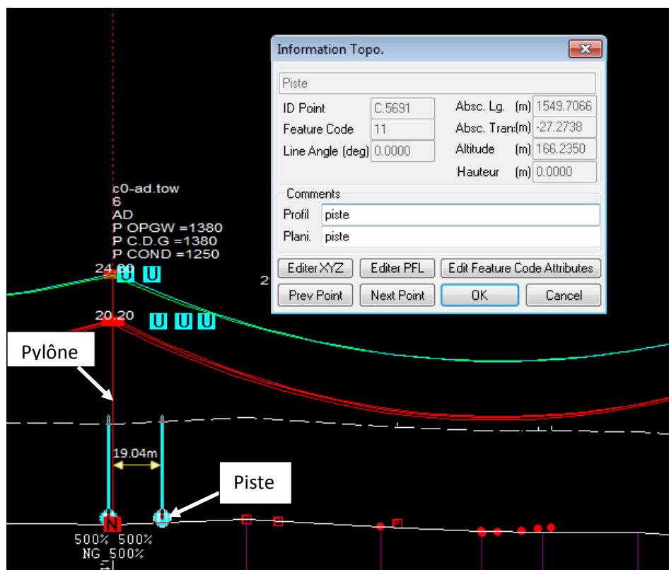
Figure III.8 : Distance horizontale entre un pylône de la ligne Hassi Messaoud – Oued El Meraa et une piste.
