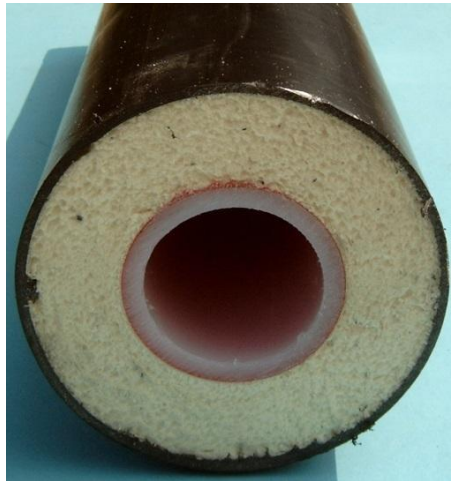
Fig I.4 : Complexe tuyau + isolant[8].
