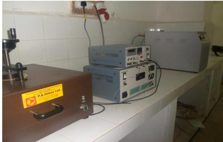
**Figure III.24 : Image globale de l'unité de mesure de la conductivité thermique**
