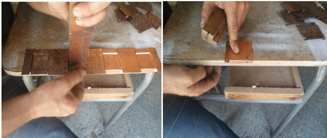
Figure III.33 : Emboutissage de la feuille pour la réalisation des empoches avec pliage
