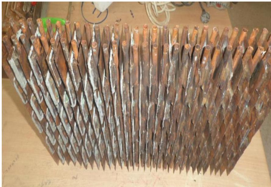
**Figure III.42 : Image de l'échangeur sans collecteurs**
