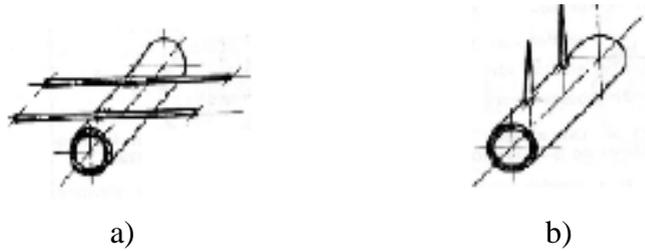
**Figure II 9 : Ailettes sous forme de barres**
