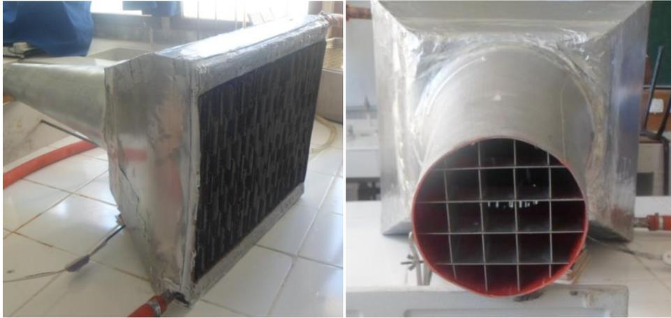
Figure III.48 : emboutissage de l'échangeur avec le circuit aéraulique.
