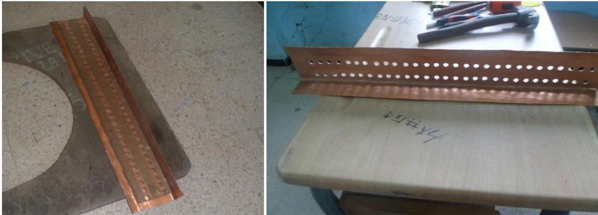
**Figure III.44 : Perçage des collecteurs**
