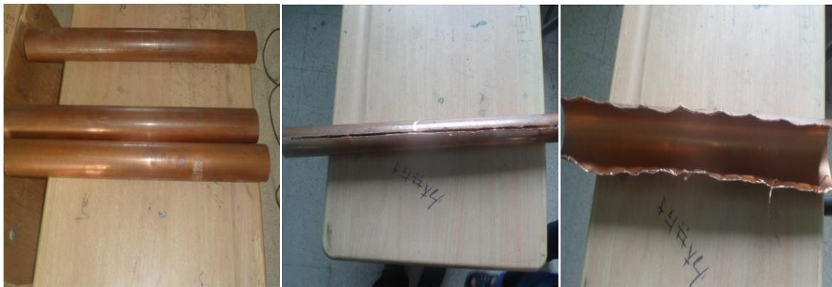
**Figure III.43 : Phase de réalisation des collecteurs**
