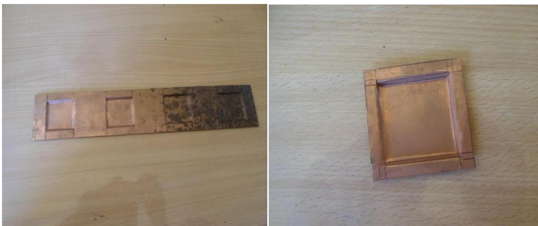
Figure III.34 : Pièces finales après emboutissage
