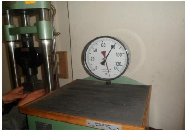
Figure III.15 : Presse pour compression des pastilles
