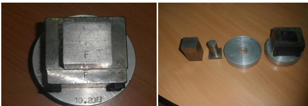
Figure III.12 : Moule utilisé pour la réalisation des pastilles
