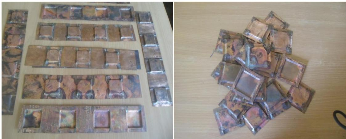
**Figure III.36 : Forme finale des pièces après soudage.**
