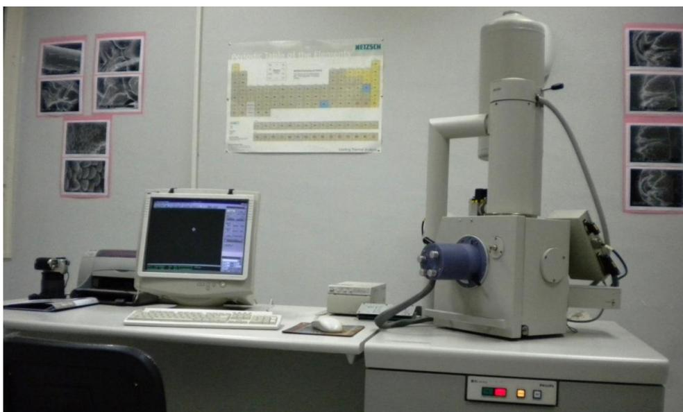
Figure III.18 : Microscope électronique à balayage
