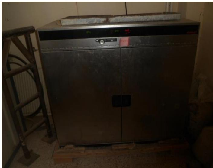
**Figure III.5 : Etuve utilisée pour séchage de la perlite**
