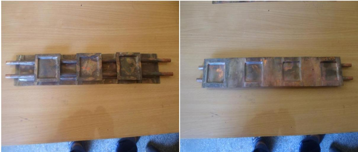
Figure III.39 : Elément de l'échangeur après soudage
