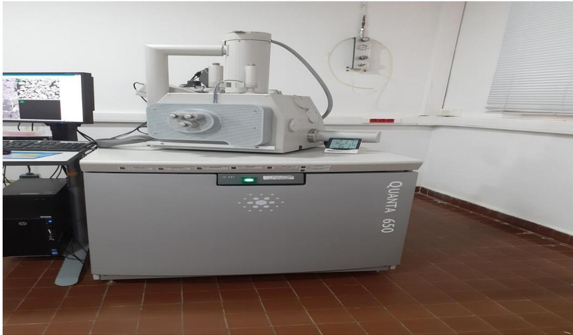
Figure 22 : Microscope électronique a balayage de marque : Quanta 650 de FEI.
