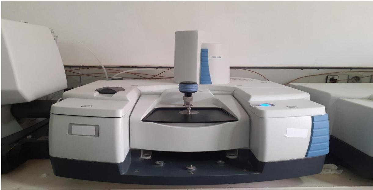
**Figure 19** : spectromètre infrarouge à transformée de Fourier de la marque thermo-scientific.
