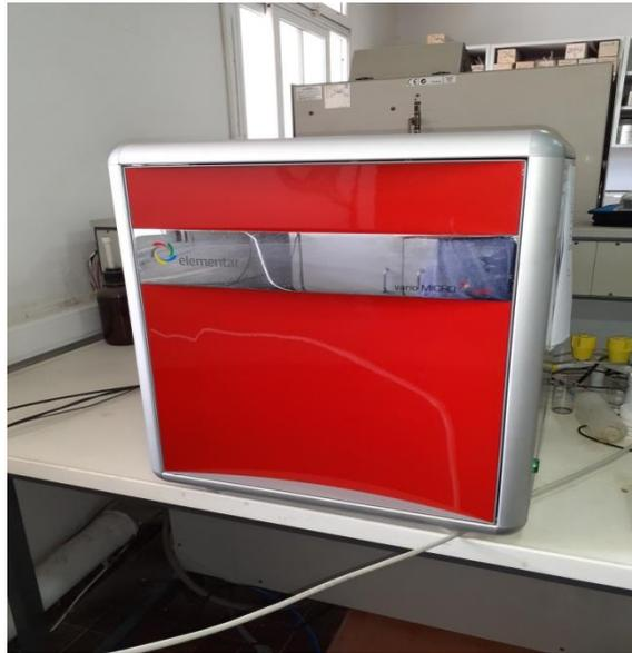
**Figure 16 :** Analyseur élémentaire de marque elementar et de model vario Micro cube.
