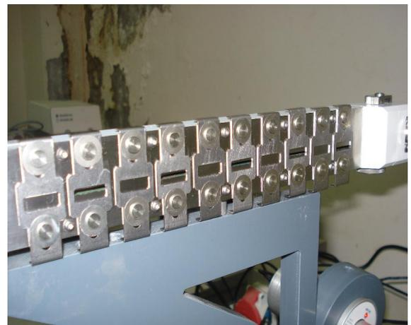
b. Antenne à fente avec deux fentes ouvertes.
