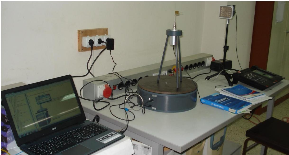
Fig III.1 Kit du système Lucas nulle-Unitrain pour les mesures d'antennes
