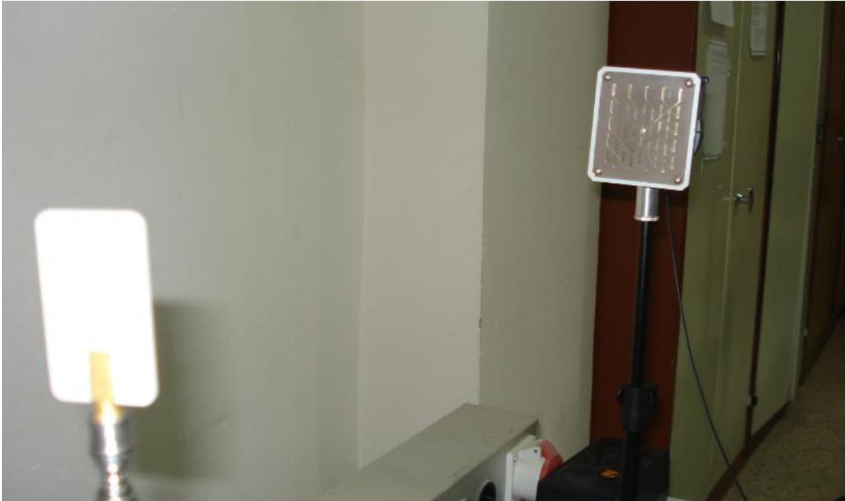
Fig III.34 Montage pour la mesure du diagramme de rayonnement de l'antenne Patch à polarisation linéaire.
