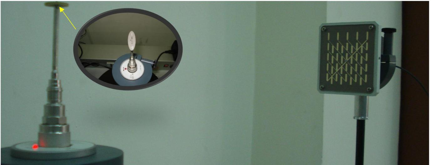
Fig III.18 Montage pour la mesure du diagramme de rayonnement de l'antenne Dipôle demi-onde
