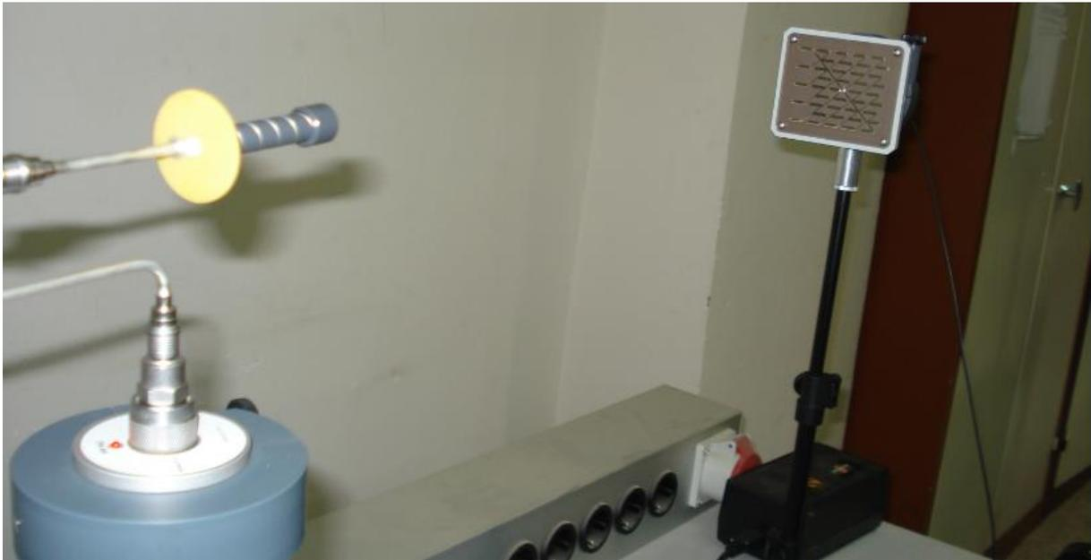
Fig III.31 Montage pour la mesure du diagramme de rayonnement de l'antenne Hélicoïdale à polarisation circulaire.
