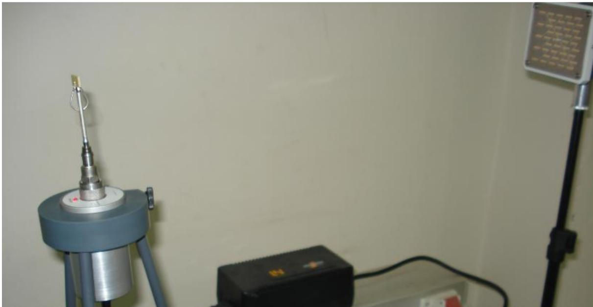
Fig III.21 Montage pour la mesure du diagramme de rayonnement de l'antenne Dipôle replié.
