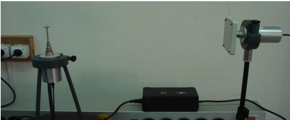
Fig III.15 Montage pour la mesure du diagramme de rayonnement de l'antenne monopole
