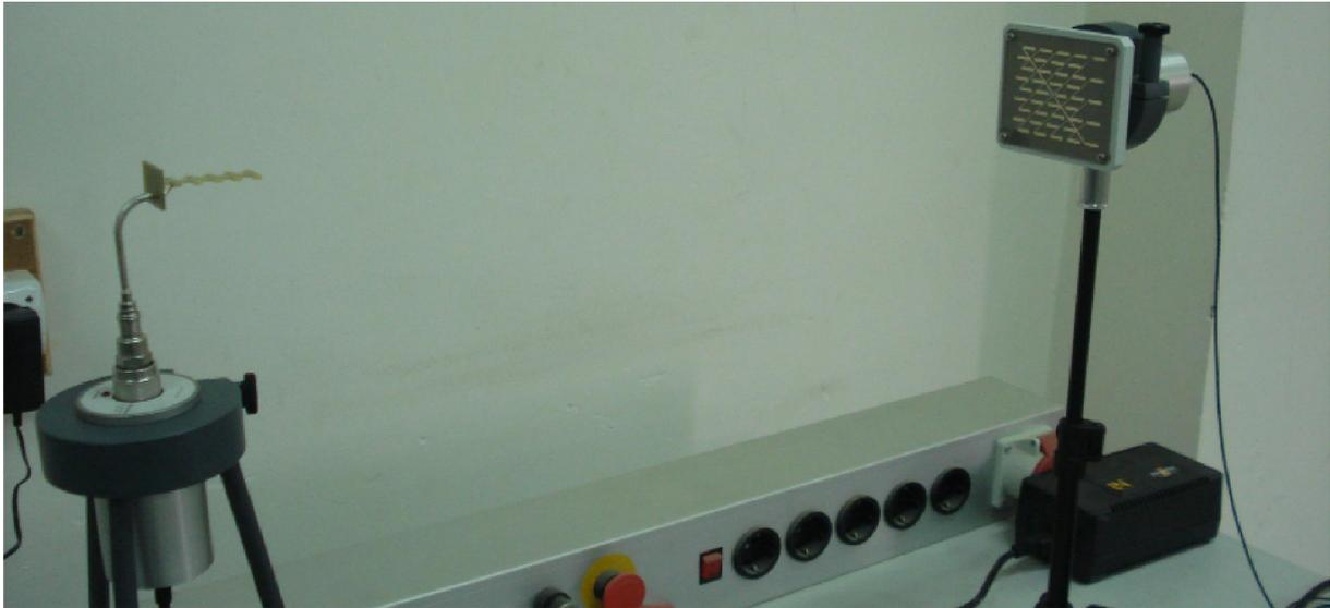
Fig III.28 Montage pour la mesure du diagramme de rayonnement de l'antenne Yagi 6 éléments
