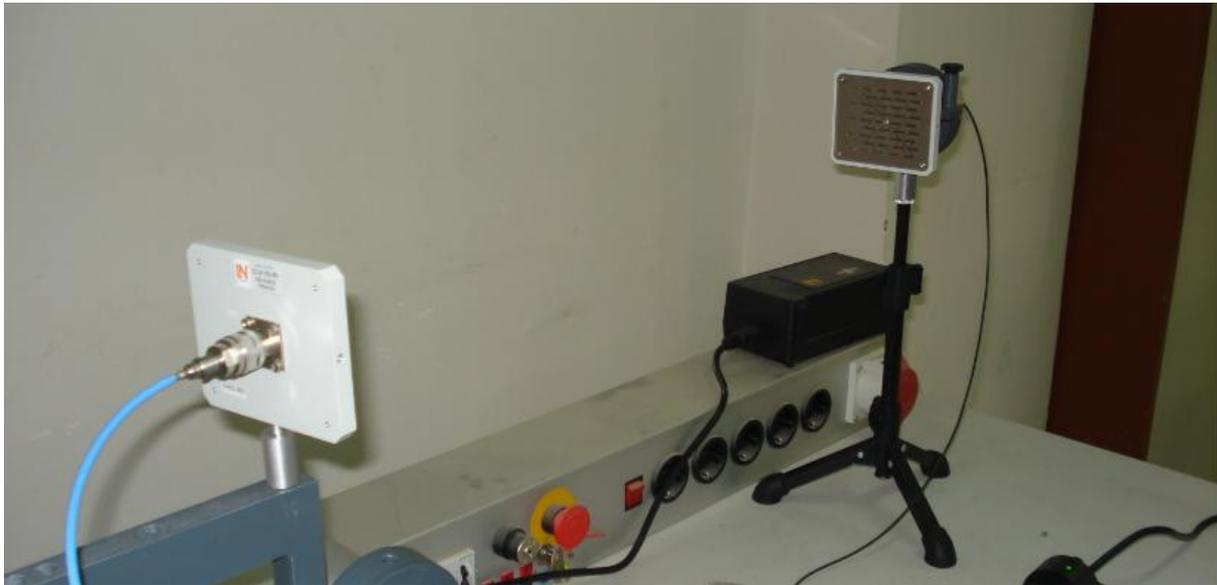
Fig. IV 9 l'émetteur et le récepteur ont des polarisations différentes
