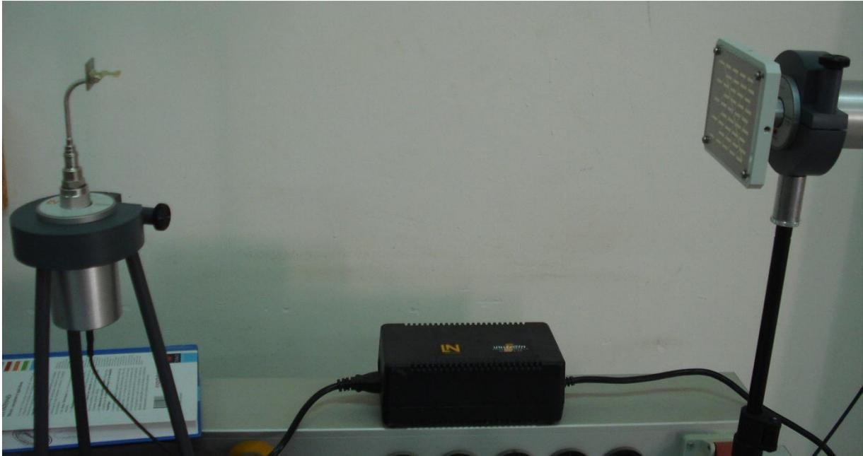
Fig III.24 Montage pour la mesure du diagramme de rayonnement de l'antenne Yagi 3 éléments
