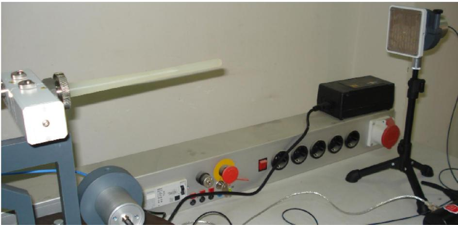
Fig III.38 Montage pour la mesure du diagramme de rayonnement de cigare
