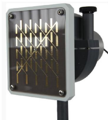
Fig III.7 Antenne de réception
