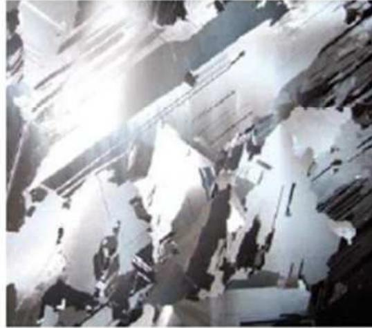
Figure 1.7: image d'un substrat de silicium multicristallin [13].
