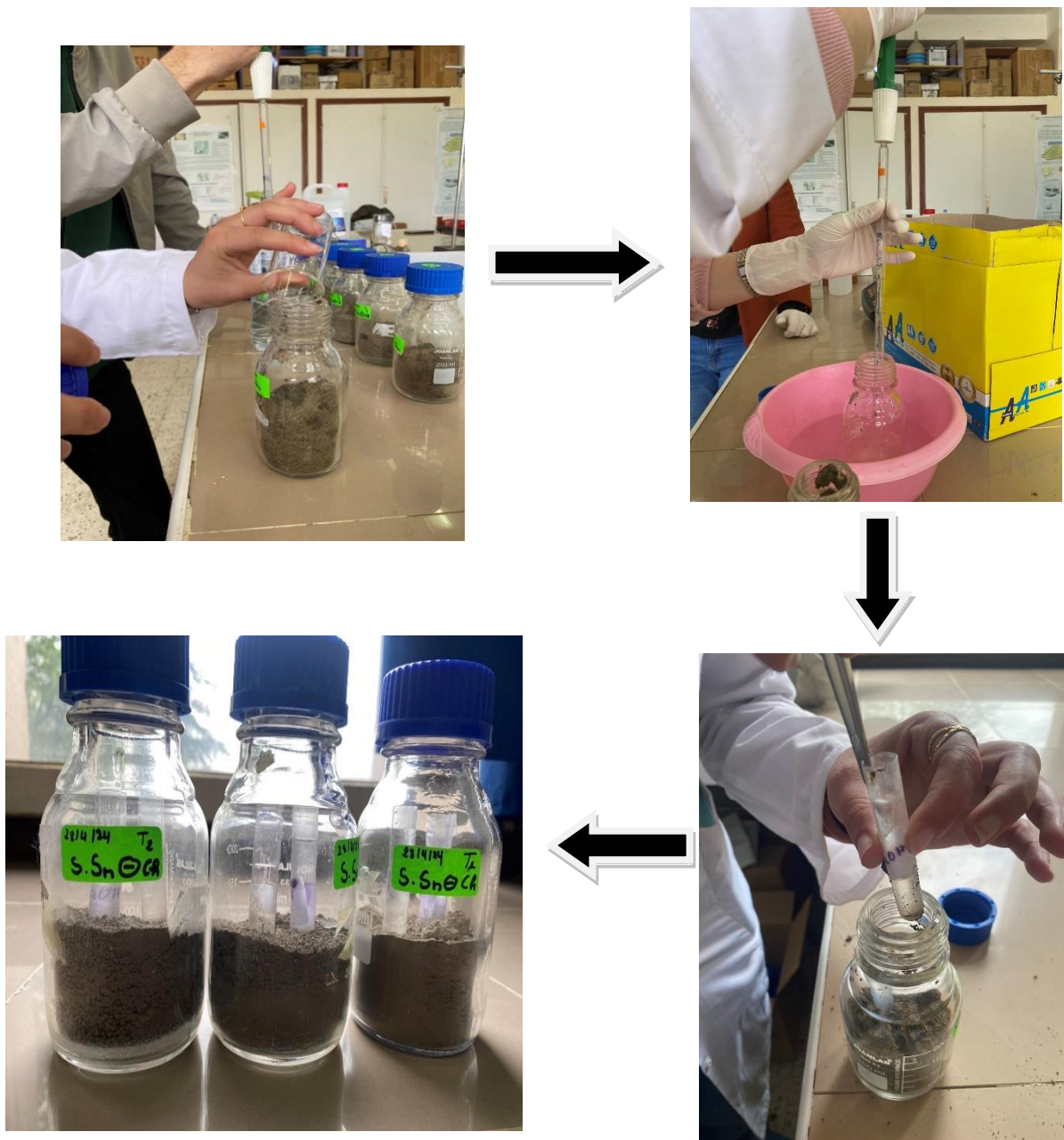
Figure 15 : Dispositif expérimental du test respirométrique)
