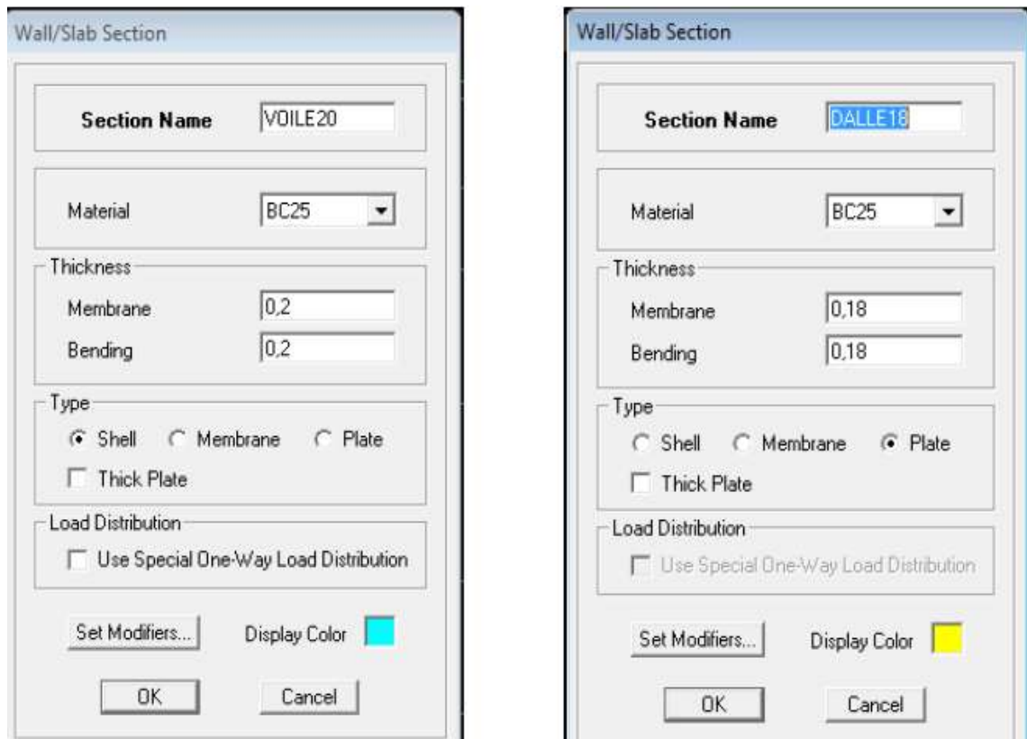
Fig. IV.2. Définition de l'épaisseur des éléments plaque.
