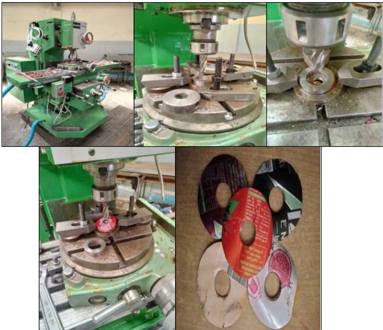
Figure 5.17 : Découpe et perçage des ailettes.
