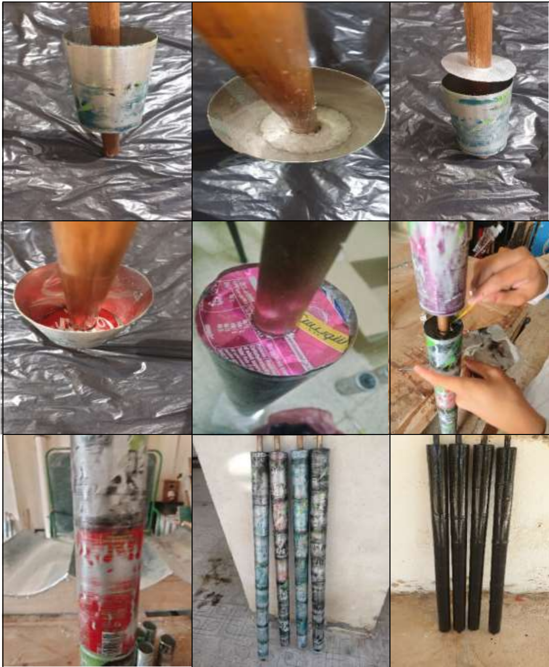
Figure 5.18 : Étapes de préparation du récepteur.
