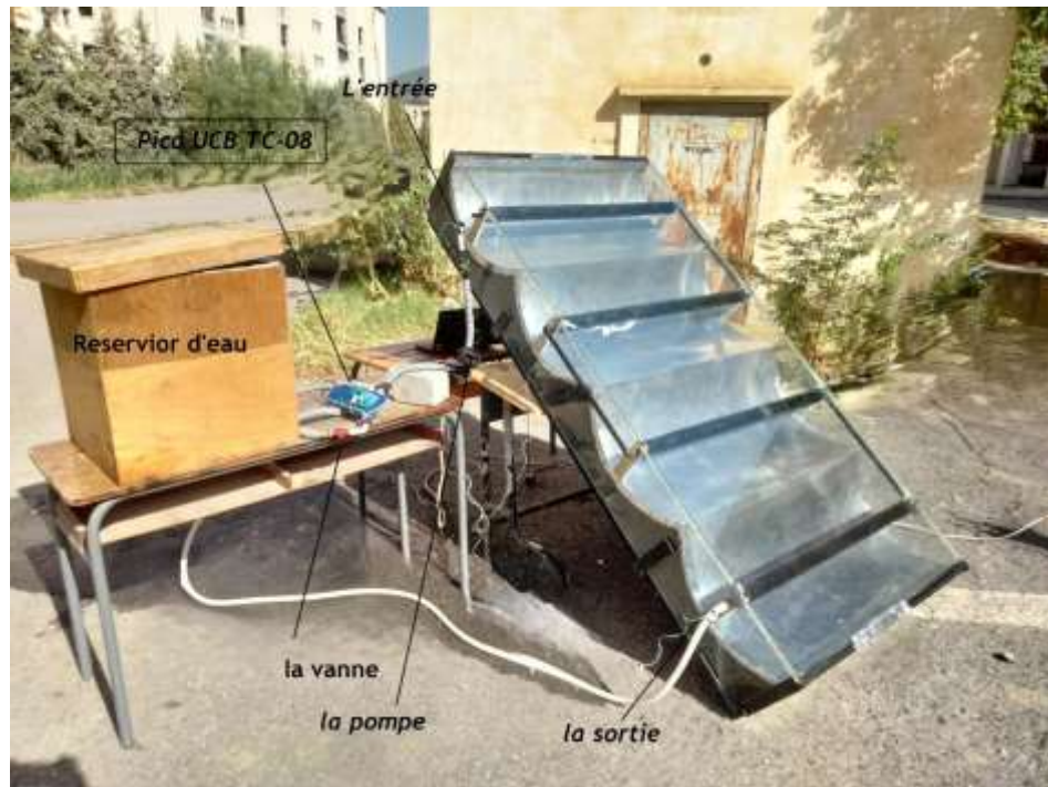
Figure 6.1 : Photo des composants du capteur solaire cylindro-parabolique
