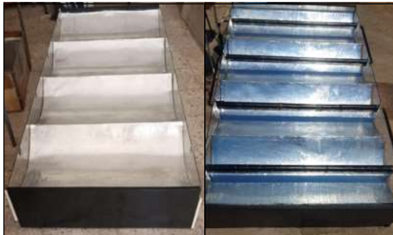
Figure 5.19 : Étapes d'installation des récepteurs à l'emplacement spécifié.
