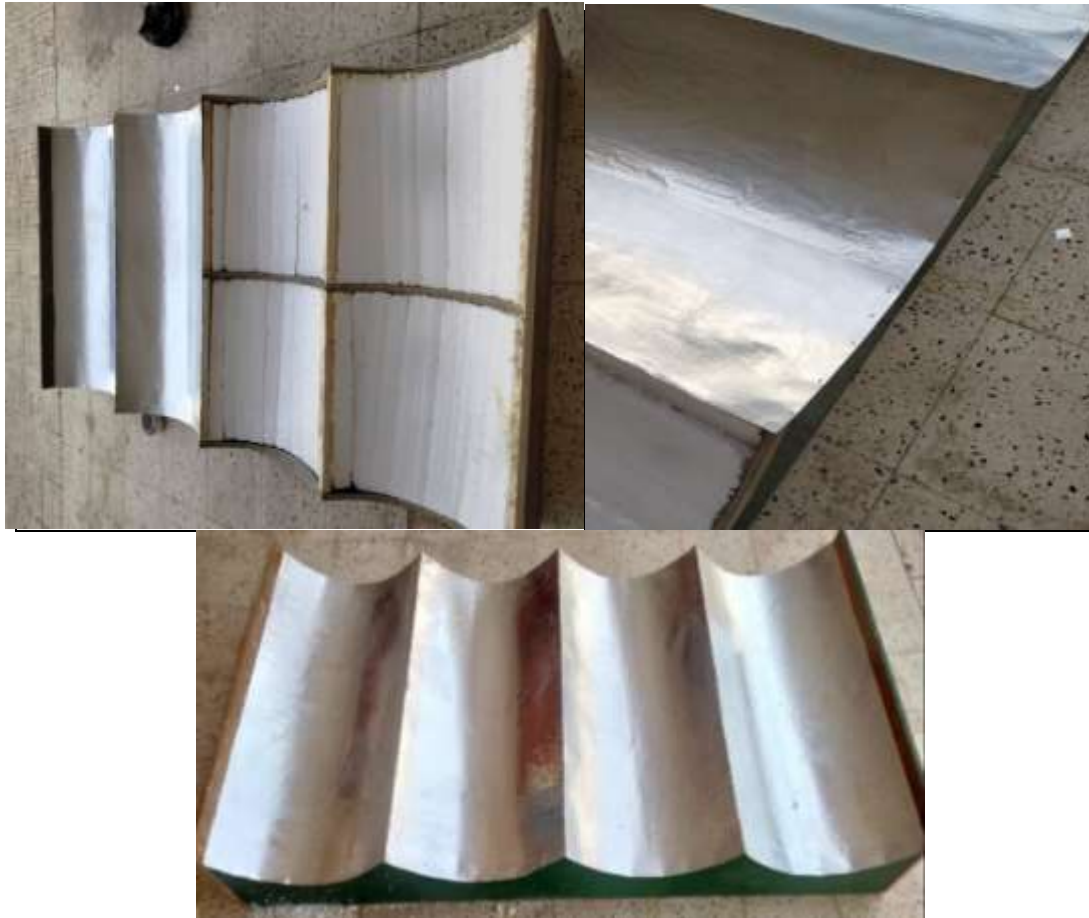
Figure 5.9 : Étapes d'installation des tôles d'aluminium.
