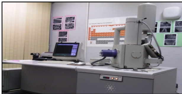
Figure II.9 Microscope électronique à balayage ESEM XL30 Philips du LPCM (UMMTO).
