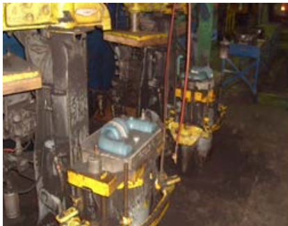
Figure II.5 Poste pour le moulage en sable
