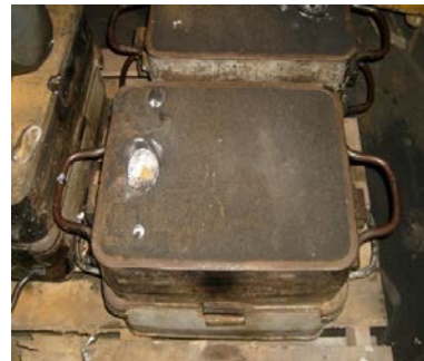
Figure II.6 Châssis supérieur – Châssis Inférieur du moule
