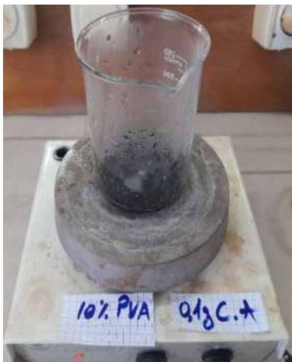
Figure 14 : Rajout du Charbon Actif (0.1 g) à la solution 10 % PVA
