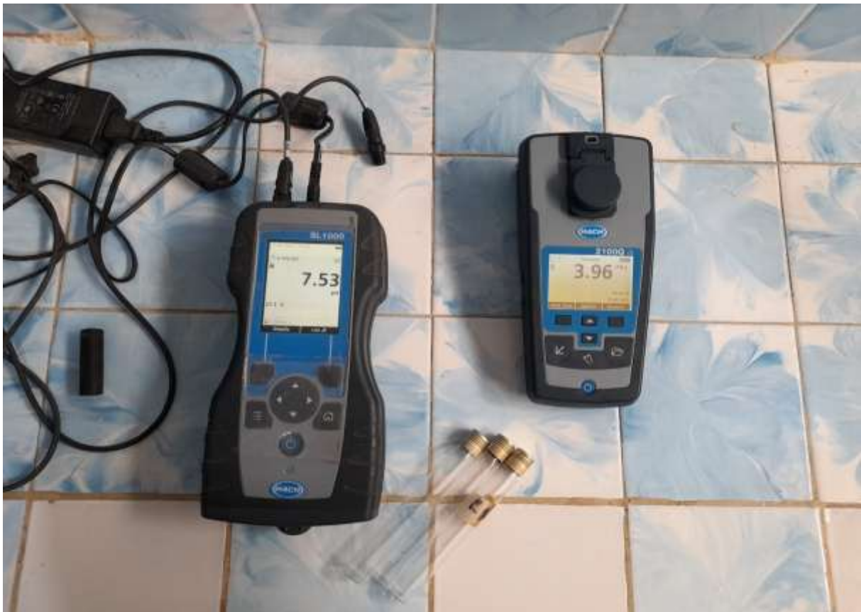
Figure 20 : Analyse de différents paramètres des échantillons à l'aide d'un multiparamètres (Hach SL 1000) et d'un turbidimètre (Hach 2100Q is)
