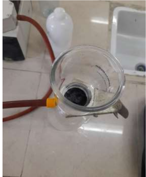
Figure 19 : Filtration de la solution salée sur rampe de filtration (Membrane PVA/CA/AB)
