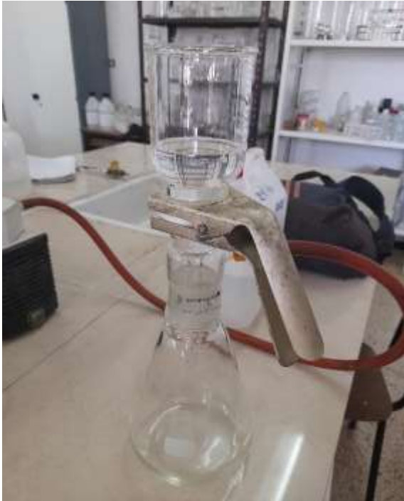
Figure 18 : Filtration de la solution salée sur rampe de filtration (Membrane PVA/AB)
