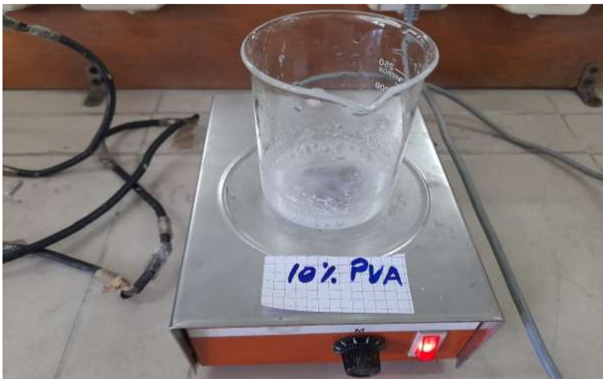
Figure 8 : Chauffage et agitation de la solution 10 % PVA
