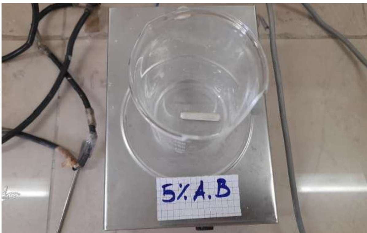
Figure 11 : Agitation de la solution 5 % Acide Borique
