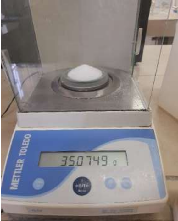
Figure 16 : Pesée de 35 g de NaCl à l'aide d'une balance de précision
