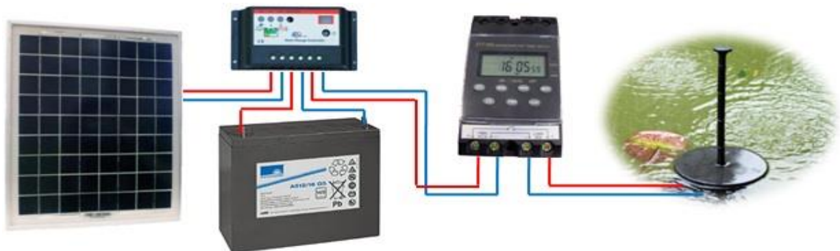
Figure (I -14) : Pompage photovoltaïque avec batterie [10].
