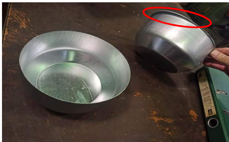
Figure I.6: Capot de ventilateur avant et après l'opération de découpage.
