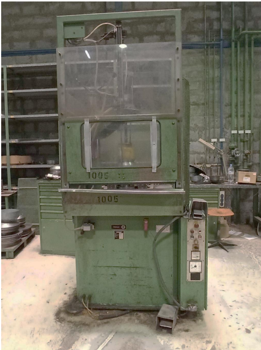
Figure I.4: Le dispositif de grillage de protection.
