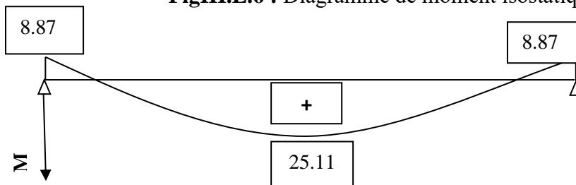
FigIII.E.6 : Diagramme de moment isostatique à l'ELS.
