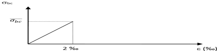
Fig.I.2 : diagramme contrainte- déformation du béton à [L'ELS].
