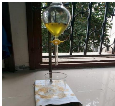
Figure 10: Séparation de deux liquides .
