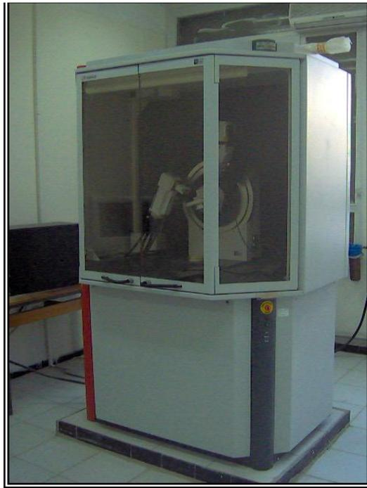
**Figure IV.6.** *Diffractomètre utilisé (Bruker D8)*
