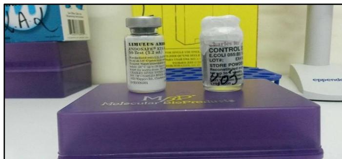
**Figure 17 :** Lysat d'amœbocytes de limule et standard de référence d'endotoxines
