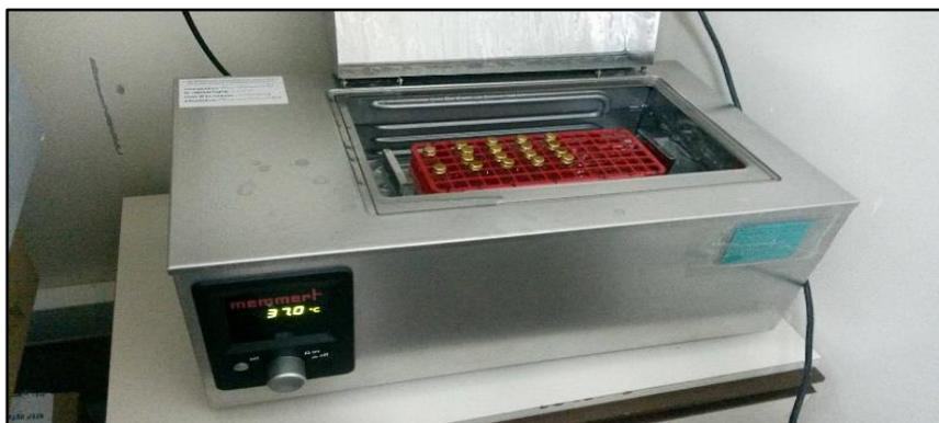
**Figure 20** : Incubation des tubes à 37°C pendant 1 h.
