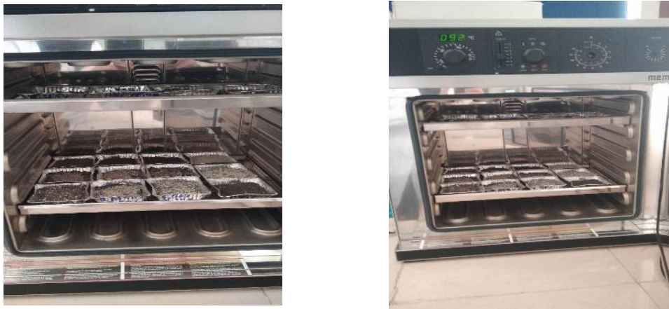
Figure 10 : composants de base et mélange des substrats dans l'étuve à 105 °C.
