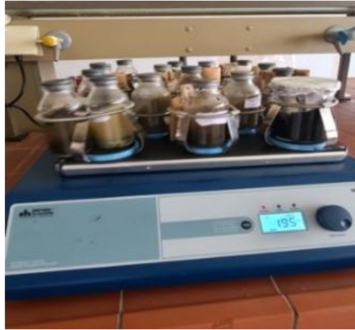
Figure 11 : agitation des échantillons avec l'agitateur électrique.
