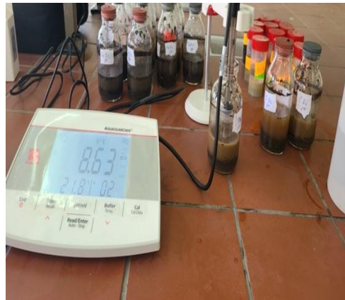
Figure 12 : mesure du pH à l'aide d'un pH-mètre.
