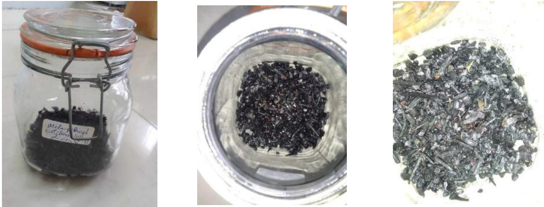
Figure 9 : test de phytotoxicité du biochar en milieu confiné, dans un bocal en verre fermé.
