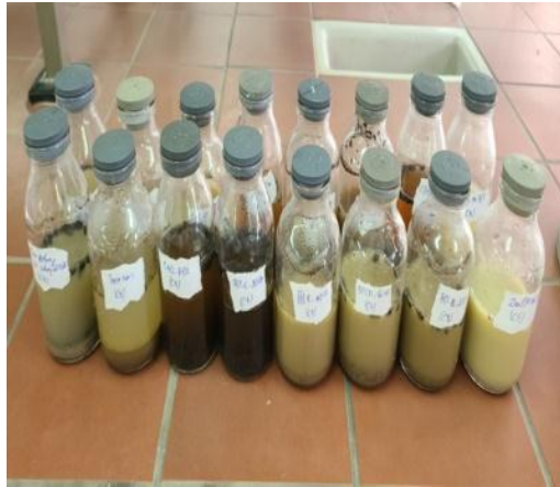
Figure 13 : flacons fermés contenant les échantillons préparés pour la mesure de la conductivité électrique.
