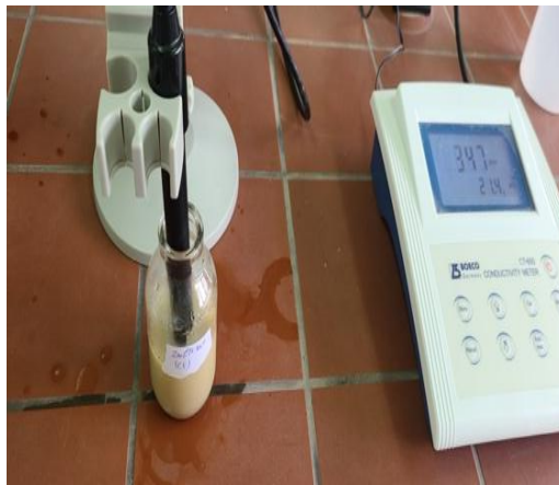
Figure 14 : mesure de la conductivité électrique à l'aide d'un conductimètre.
