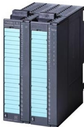
Figure 3.6 : les modules d'entrées/sorties.
