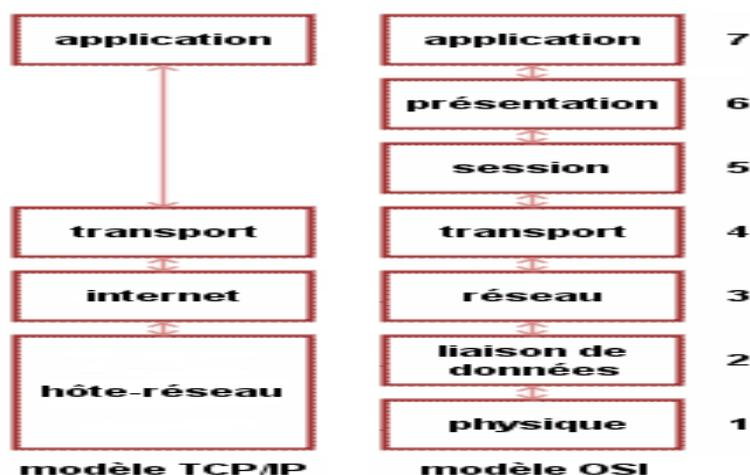
Figure I.8 : TCP/IP et le modèle OSI
