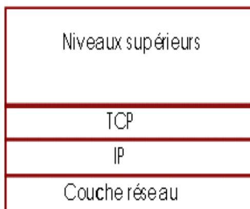
**Figure I-10** Implantation du protocole TCP dans le modèle TCP/IP
