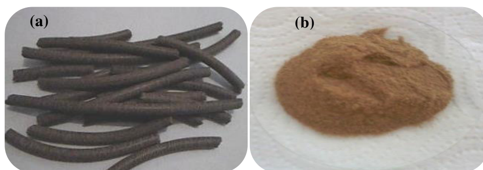
Figure IV-1 : Résidu de l'extraction de l'huile à partir des graines de figues de barbarie : a) avant broyage ; b) après broyage
