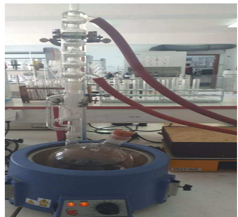
Figure 9 : Montage de l'extraction de l'huile par Soxhlet
