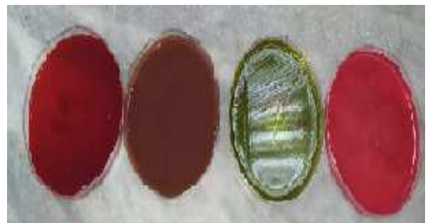
Figure 35: Recherche de contamination dans le gommage
