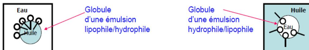
Figure 4 : Schématisation de globules d'émulsion stabilisés par des molécules de Tensioactifs
