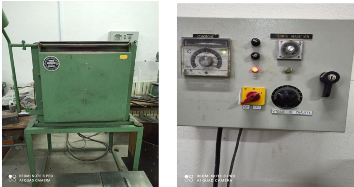
Figure III.2 : four électrique utilisé et son régulateur.
