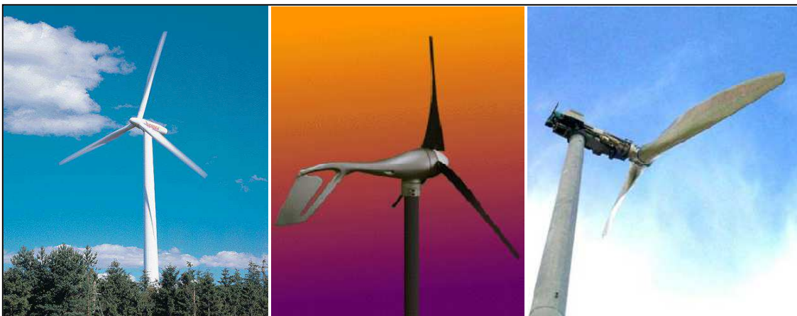
Fig I.8 Eoliennes à axe horizontal.
