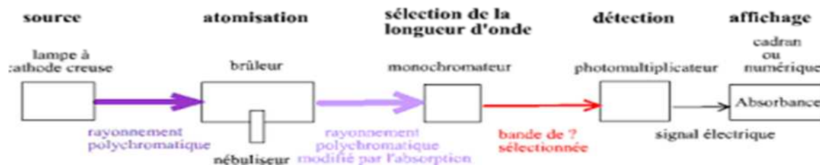
Figure III.10 : Principe de fonctionnement d'un spectrophotomètre d'absorption atomique.
