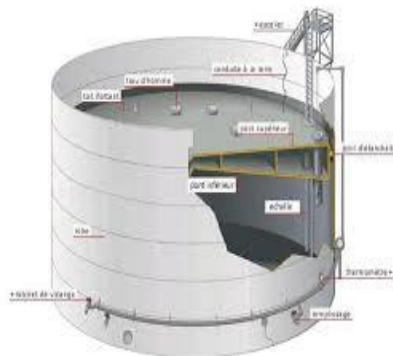
Figure II.9 : Bac à toit flottant [06]
