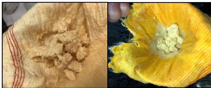
Figure II.2. Cellulose avant(gauche) et après (droite) traitement à l'eau de javel.
