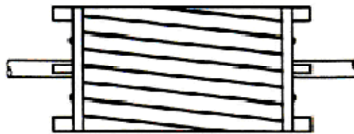
Fig.I.6. La disposition en biais des barres rotoriques.
