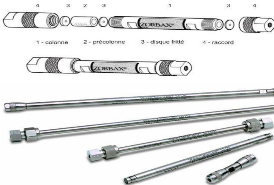
Figure 08 : Colonne standard et pré colonne de HPLC
