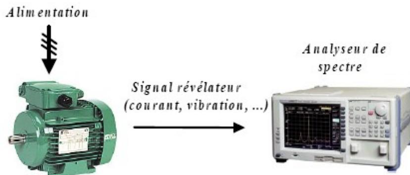
*Fig.I.6 Principe de la surveillance par analyse spectrale*
