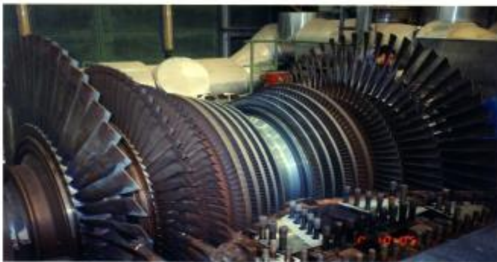
Figure I.5 : Photo réelle du corps BP de la turbine (double flux)
